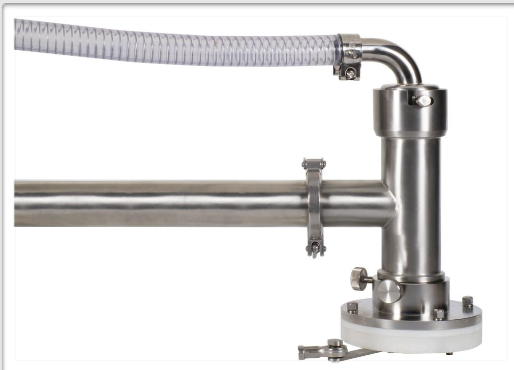
*Sincronizando dos embutidoras, con la boquilla rellena se puede conseguir una croqueta rellena de distintos sabores.*
